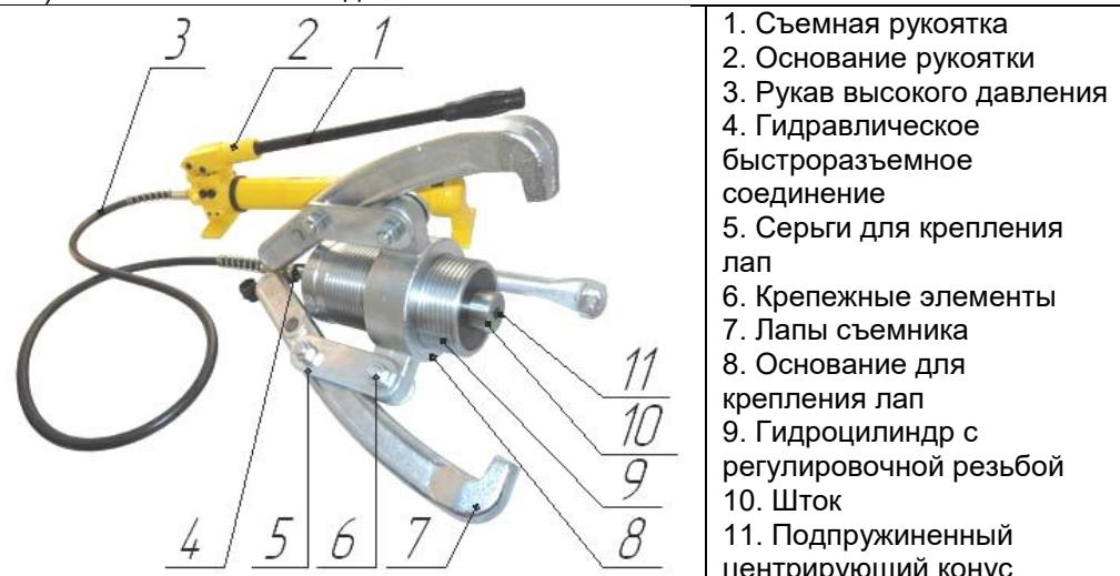
3.1. В лапах съемника 7 предусмотрены два отверстия, для соединения с серьгами 5. Съемники СГ-5Н, СГ-10Н, СГ-20Н, СГ-30Н, СГ-50Н можно использовать как с тремя, так и с двумя лапами (захватами). При использовании съемника с двумя захватами, лапы крепятся к диаметрально противоположным проушинам основания 8 с помощью серег 5. У этих моделей на основании для
