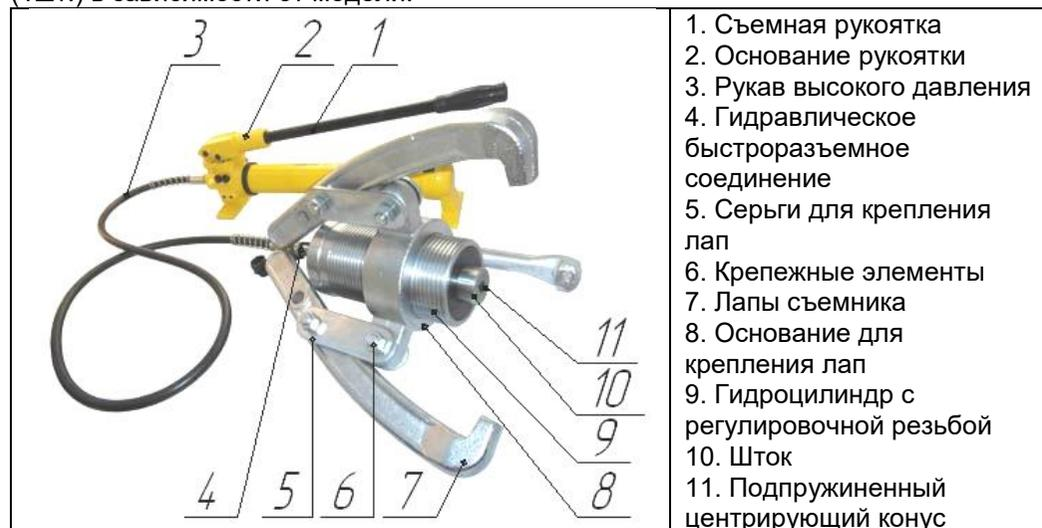
3.1. В лапах съемника 7 предусмотрены два отверстия, для соединения с серьгами 5. Съёмники СГ-5Н, СГ-10Н, СГ-20Н, СГ-30Н, СГ-50Н можно использовать как с тремя, так и с двумя лапами (захватами). При использовании съемника с двумя захватами, лапы крепятся к диаметрально противоположным проушинам основания 8 с помощью серег 5. У этих моделей на основании для
