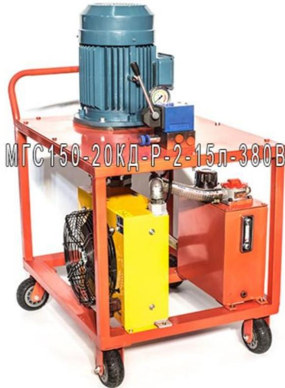
**Маслостанция с бензоприводом МГС150-20КД-Р-2-15л-380В для динамического инструмента (20-40 л/мин, 150 бар)**
